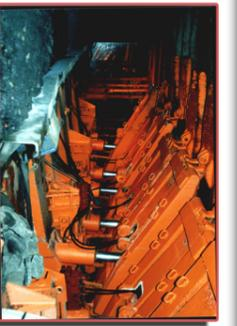
Taille à soutènement marchant hydraulique, à partir de 1960.
